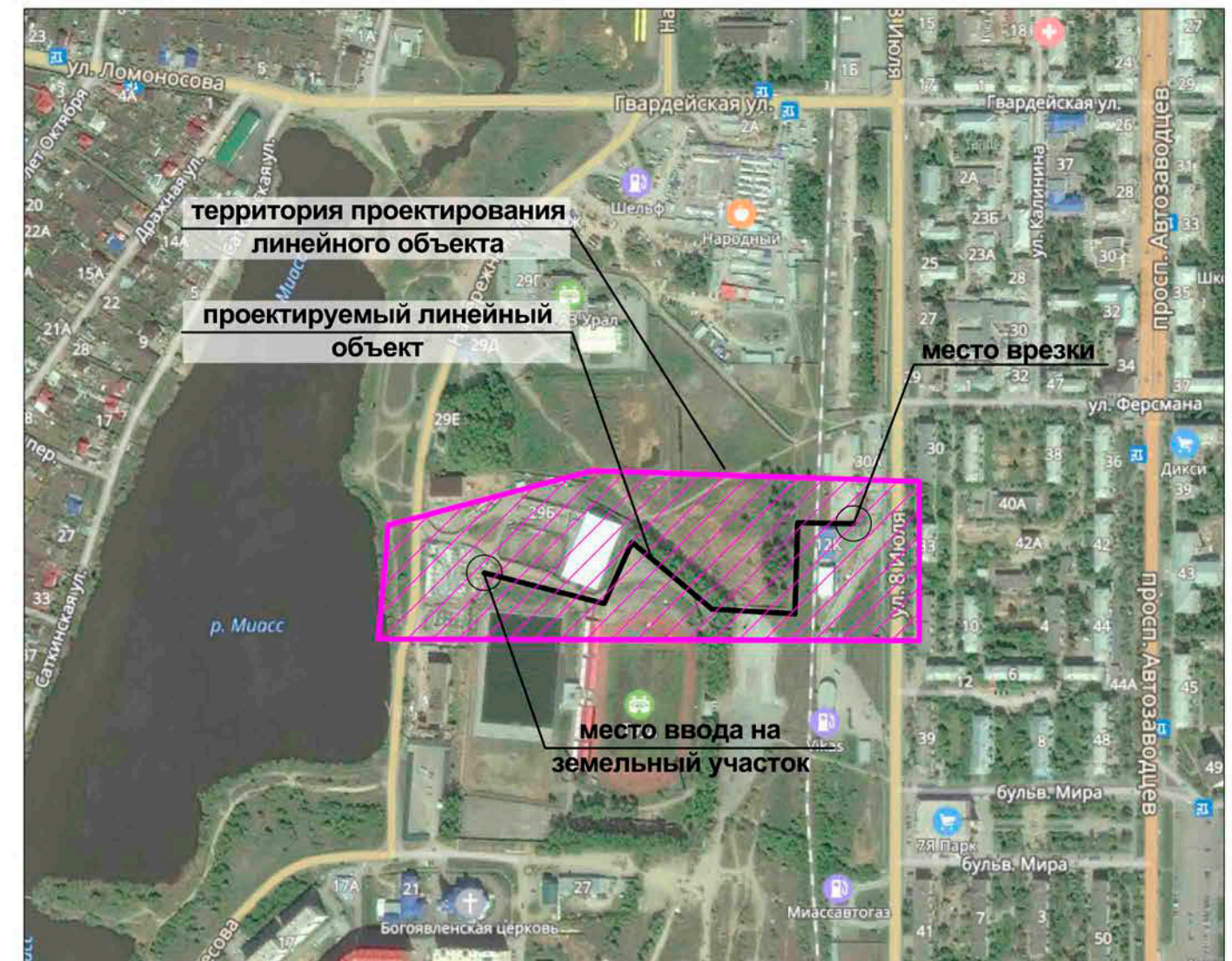
Фрагмент электронной карты с отображением сведений трассировки проектируемого линейного объекта
